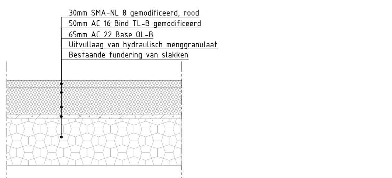
Verhardingsconstructie 10c (f.p.v. fietspad) Schaal 1:10
